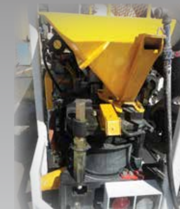
ALIVA 257 Una bomba de hormigón proyectado húmedo/seco
