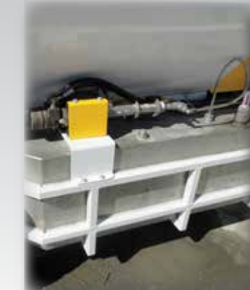
Un sistema de dosis y un tanque para aceleradores líquidos
