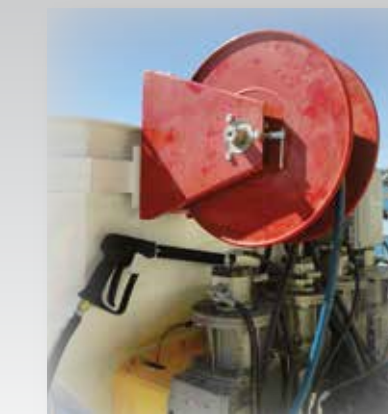
Una manguera y una lanza para limpieza de alta presión
